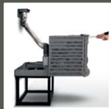
Dettaglio sistema di estrazione per caricamento pellet
